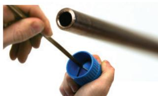
Desbarbe cuidadosamente la perforación interior y el borde exterior del punto de corte del conducto del tubo.
