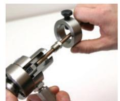
Inserte la tubería a reborear en la abertura de la herramienta de ajuste hasta que esté correctamente sobrepuesta el tope.
