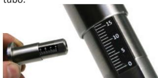
Ajuste girando el manguito hasta la medida deseada (ver tabla al lado). La imagen de arriba muestra un ejemplo de 16.5 mm de valor de ajuste.
