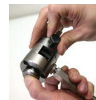
Apriete primero firmemente con la mano el tornillo de sujeción y finalmente con una llave tubular de 17 mm.
