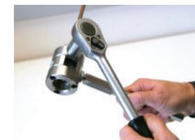
Abra el anillo de apriete y saque la mordaza de sujeción y la tubería reboreada del BeePro.
