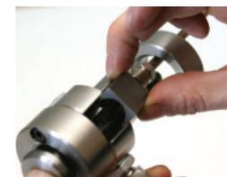
Finalmente coloque la mordaza de sujeción superior rectangular en el BeePro y presione la misma sobre la inferior hasta que esté correctamente sobrepuesta.
