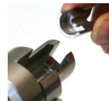
Inserte la mordaza de sujeción interior redondeada en el BeePro. Ponga atención en la posición de montaje correcta de la mordaza de sujeción en dirección a la placa roscada.
