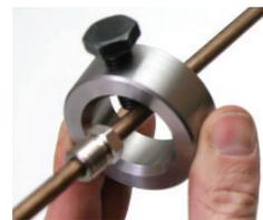
Deslice el anillo de apriete y un tornillo de conexión sobre el tubo de conducción a reborear. Las personas diestras deberán tomar el BeePro con la mano derecha y los zurdos con la mano izquierda.
