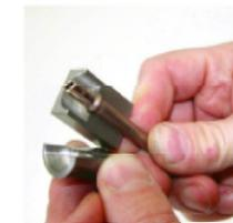
Sollte sich leichter Abrieb am Bördel zeigen, so können Sie diesen mit feinem Schleifstein entfernen. FERTIG.
