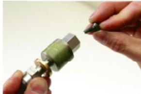
Setzen Sie den benötigten Pressstempel und das mehrteilige Axialrollenlager, in die Stempelaufnahme. Ziehen Sie die Senkkopfschraube mit einem 4er Inbusschlüssel mäßig an.
