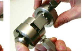
Schieben Sie den Spannring über das Gehäuse des BeePro, bis dieser anliegt. Achten Sie auf die korrekte Lage der Rohrleitung.
