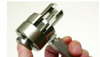
Fügen Sie das Einstellwerkzeug so ein, dass es die untere Spannbacke an die hintere Gehäusebegrenzung drückt.
