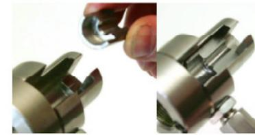
Legen Sie die untere, abgerundete Spannbacke in den BeePro ein. Achten Sie auf die korrekte Einbaulage der Spannbacke in Richtung der Gewindeplatte.
