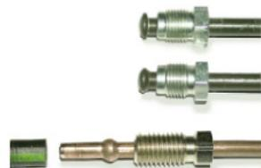
Verwenden Sie bei der Montage einer CIT-Bördelverbindung immer einen neuen Dichtungsgummi.
