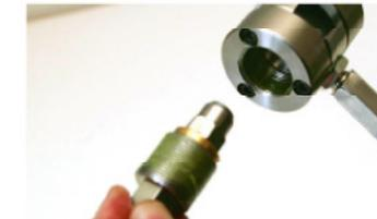
Legen Sie das Einstellwerkzeug beiseite und setzen Sie die vorbereitete Stempelaufnahme in den BeePro ein.
