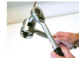
Öffnen Sie den Spannring und heben Sie die Spannbacken und die gebördelte Leitung aus dem BeePro heraus.
