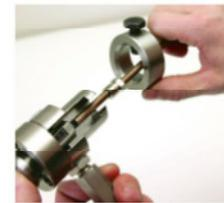
Führen Sie die zu bördelnde Rohrleitung bis zum Anschlag in die Öffnung des Einstellwerkzeuges ein.
