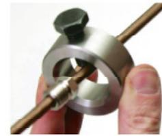
Schieben Sie den Spannring und eine Anschlusschraube über die zu bördelnde Rohrleitung. Rechtshänder nehmen den BeePro in die rechte Hand – Linkshänder in die linke.
