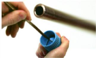
Entgraten Sie die Innenbohrung und Außenkante der Schnittstelle der Rohrleitung sorgfältig.
