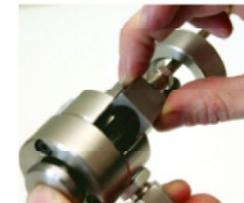
Anschließend legen Sie die rechteckige, obere Spannbacke in den BeePro ein und drücken diese auf die untere, bis sie ordentlich aufliegt.
