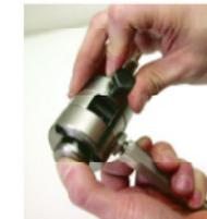
Drehen Sie die Spannschraube zuerst handfest und anschließend mit einem 17mm-Steckschlüssel mit min. **40Nm** fest an.
