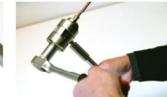
Drehen Sie die Stempelaufnahme gleichmäßig bis zum Anschlag ein. Sobald der Endpunkt erreicht ist, können Sie die Stempelaufnahme herausdrehen.
